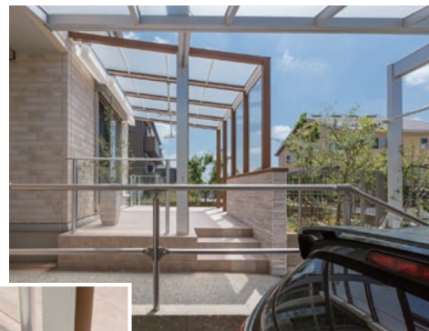
梁をのびしたカーポートの柱の位置と、テラスの出入り口を、綿密に計算してバランスよく納めました。柱がじゃまにならず、動線もスムーズです。
